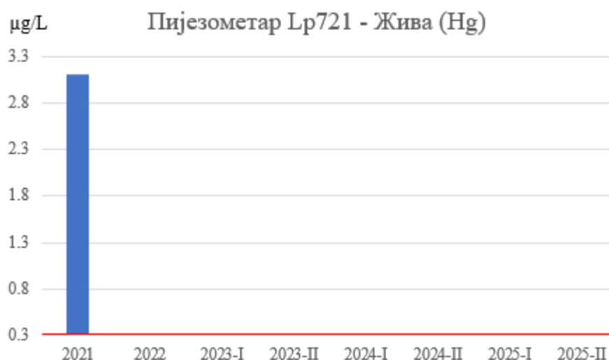
Слика 62. Концентрације живе у подземној води пијезометра Lp-721
