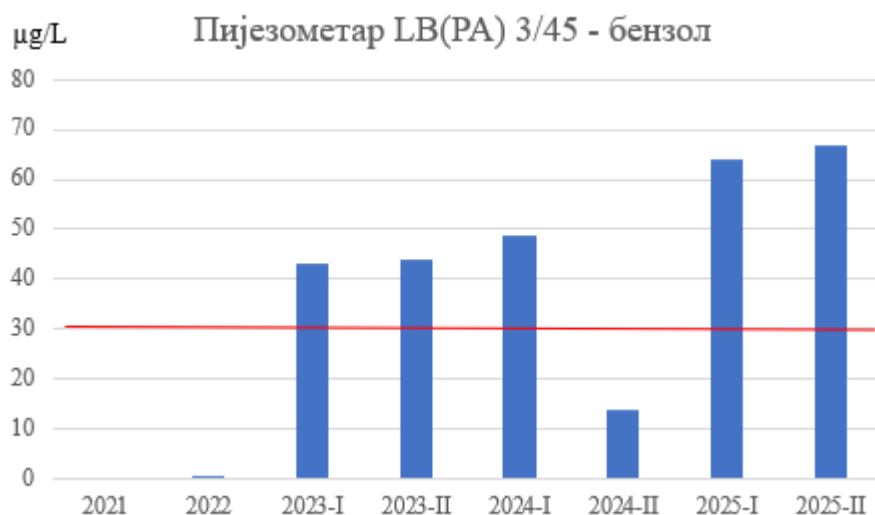
Слика 26. Концентрације бензола у подземној води пијезометра LB(PA) 3/45
