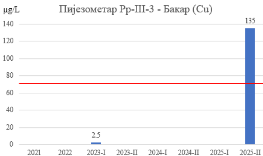
Слика 65. Концентрације бакра у подземној води пијезометра Рр-III-3
