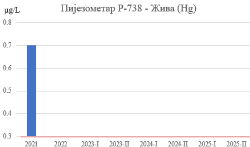
Слика 41. Концентрације живе у подземној води пијезометра Р-738
