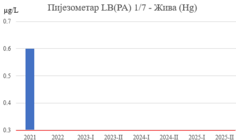
Слика 4. Концентрације живе у подземној води пијезометра LB(PA) 1/7
