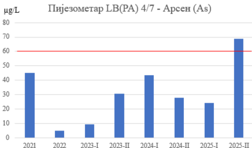
Слика 35. Концентрације арсена у подземној води пијезометра LB(PA) 4/7
