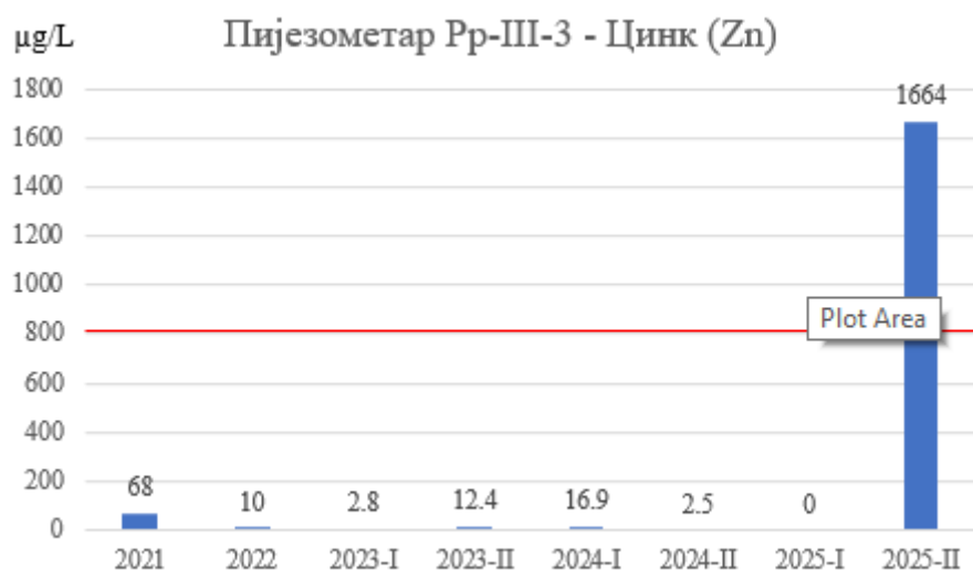
Слика 66. Концентрације цинка у подземној води пијезометра Рр-III-3
