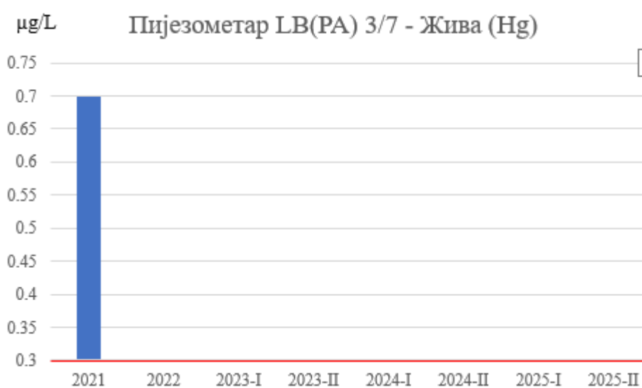
Слика 13. Концентрације живе у подземној води пијезометра LB(PA) 3/7
