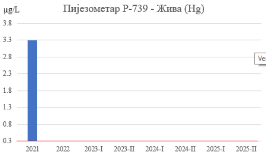
Слика 45. Концентрације живе у подземној води пијезометра Р-739
