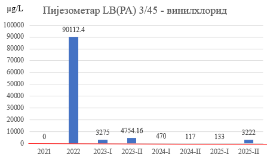
Слика 30. Концентрације винилхлорида у подземној води пијезометра LB(PA) 3/45
