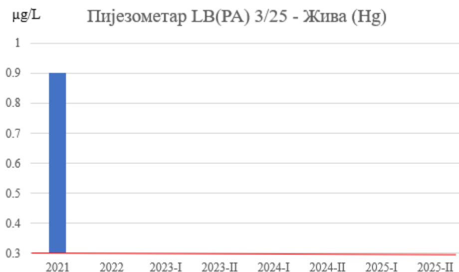
Слика 24. Концентрације живе у подземној води пијезометра LB(PA) 3/25
