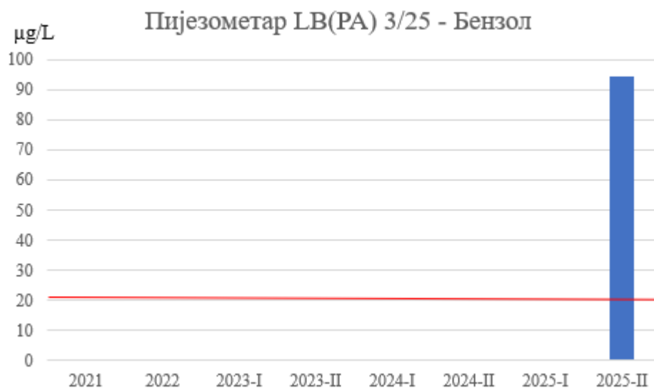
Слика 20. Концентрације бензола у подземној води пијезометра LB(PA) 3/25
