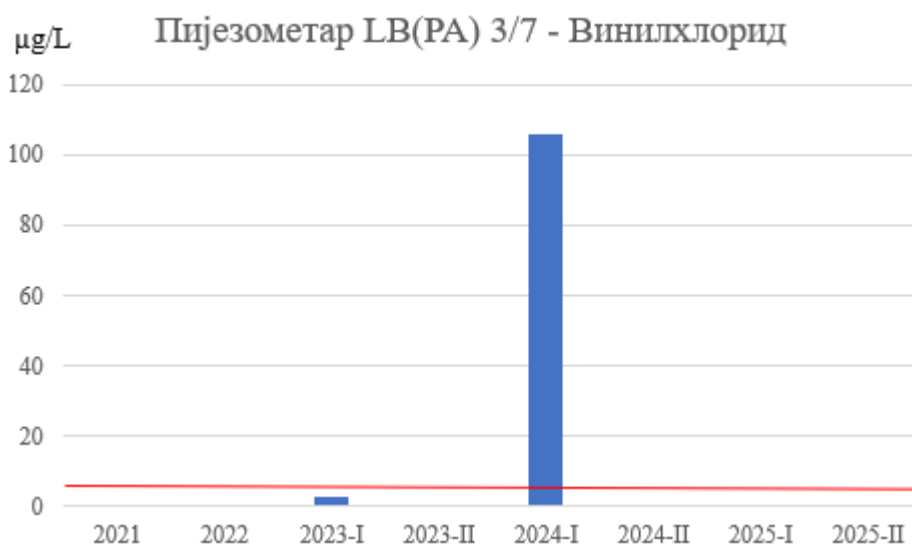
Слика 12. Концентрације винилхлорида у подземној води пијезометра LB(PA) 3/7
