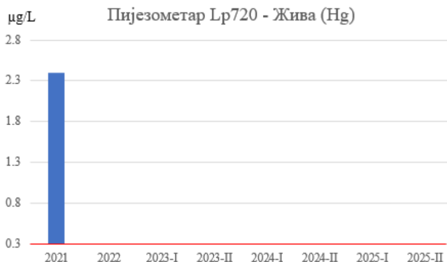
Слика 56. Концентрације живе у подземној води пијезометра Lp-720
