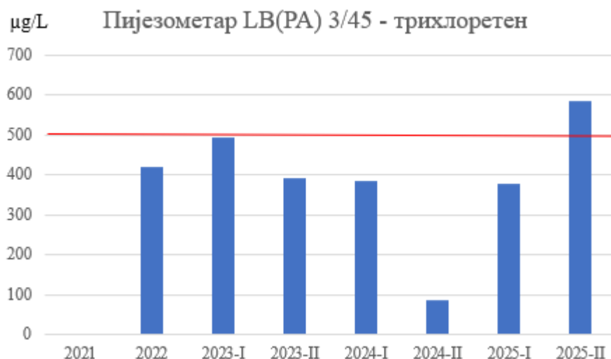
Слика 29. Концентрације трихлоретена у подземној води пијезометра LB(PA) 3/45
