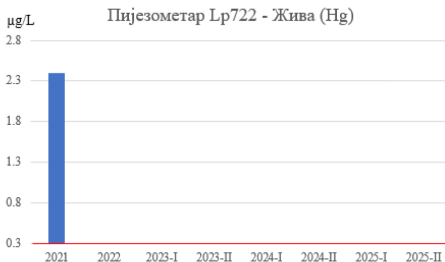
Слика 59. Концентрације живе у подземној води пијезометра Lp-722
