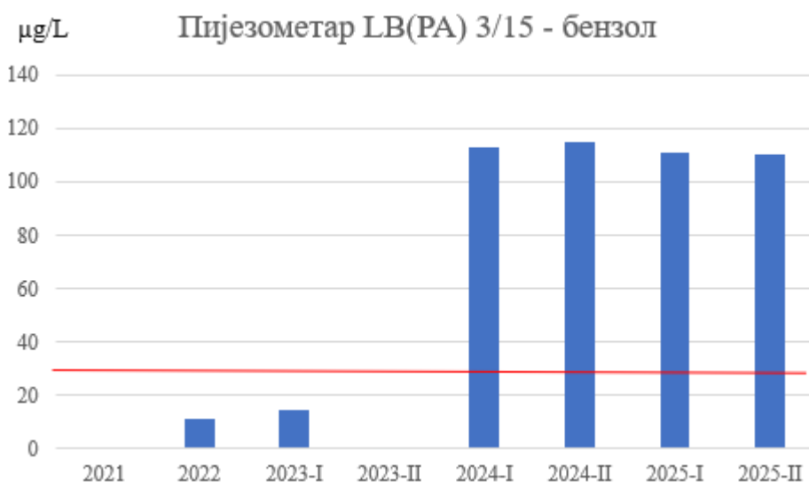
Слика 15. Концентрације бензола у подземној води пијезометра LB(PA) 3/15
