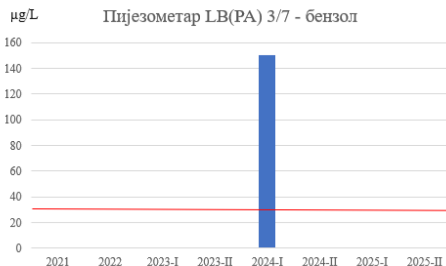
Слика 10. Концентрације бензола у подземној води пијезометра LB(PA) 3/7
