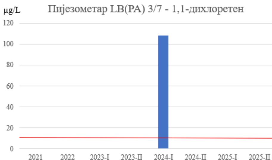
Слика 11. Концентрације 1,1-дихлоретана у подземној води пијезометра LB(PA) 3/7
