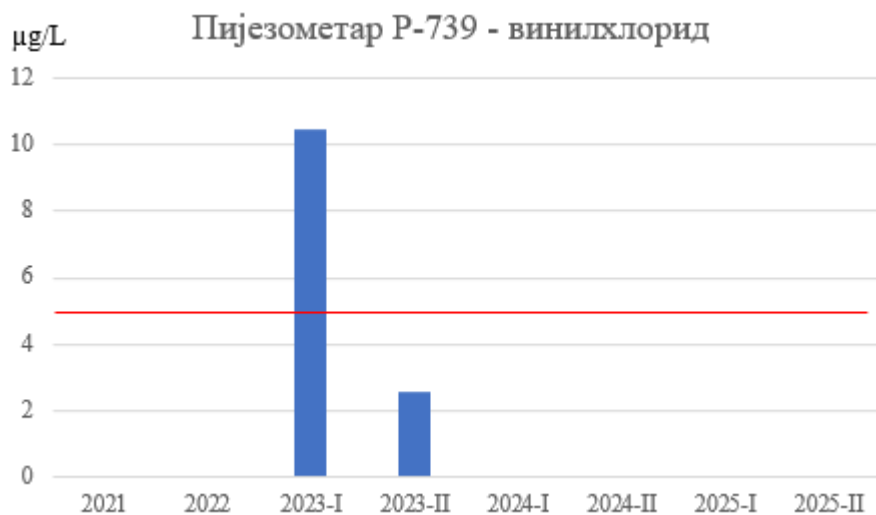
Слика 46. Концентрације винилхлорида у подземној води пијезометра Р-739
