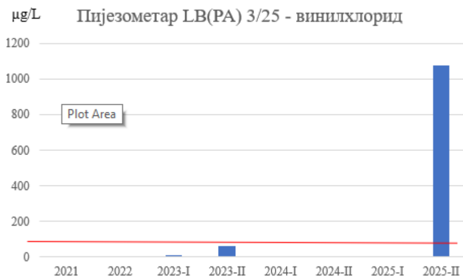
Слика 23. Концентрације винилхлорида у подземној води пијезометра LB(PA) 3/25
