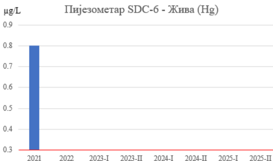
Слика 53. Концентрације живе у подземној води пијезометра SDC-6
