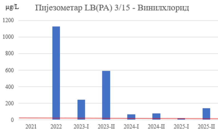
Слика 17. Концентрације винилхлорида у подземној води пијезометра LB(PA) 3/15
