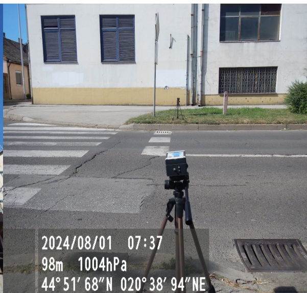
Слика 14. Аутоматско бројање саобраћаја у улици Жарка Зрењанина
