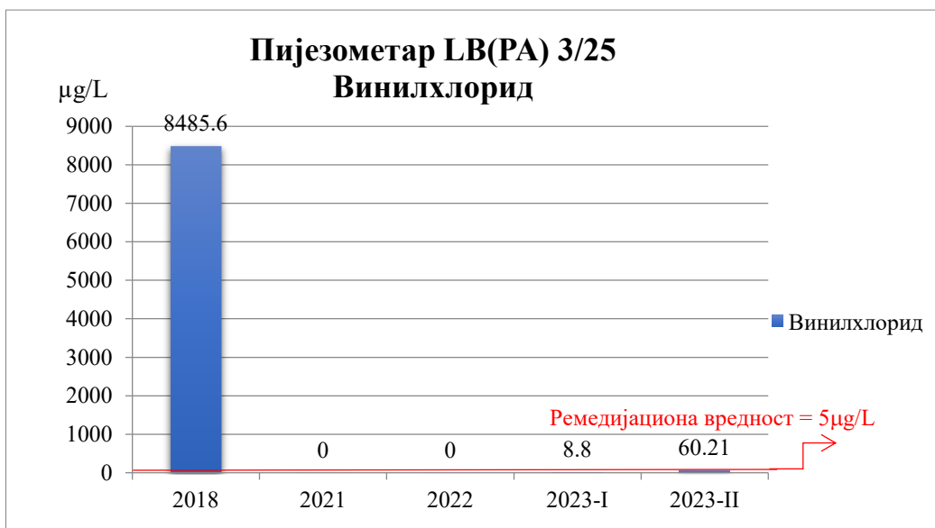
Слика 27. Концентрације винилхлорида у подземној води пијезометра LB(PA) 3/25
