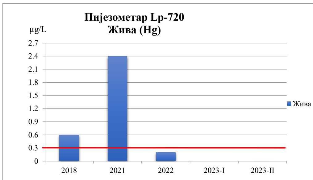
Слика 64. Концентрације живе у подземној води пијезометра Lp-720
