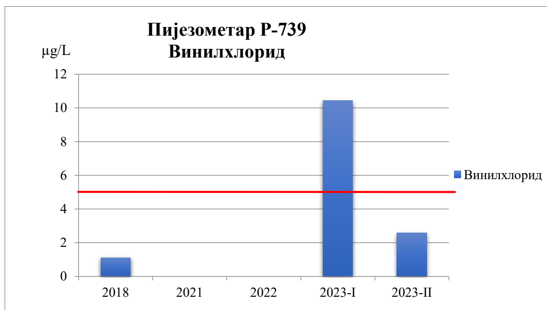
Слика 51. Концентрације винилхлорида у подземној води пијезометра P-739
