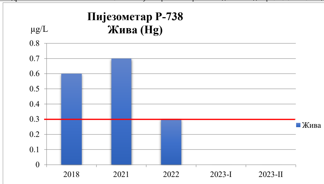
Слика 47. Концентрације живе у подземној води пијезометра Р-738
