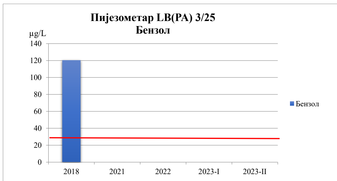
Слика 23. Концентрације бензола у подземној води пијезометра LB(PA) 3/25
