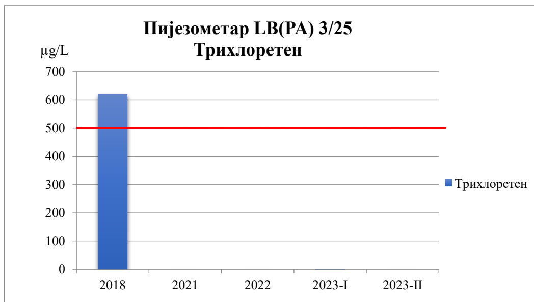
Слика 26. Концентрације трихлоретена у подземној води пијезометра LB(PA) 3/25
