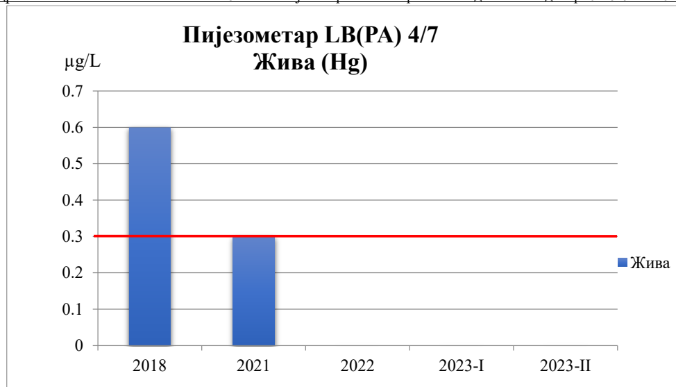
Слика 38. Концентрације живе у подземној води пијезометра LB(PA) 4/7
