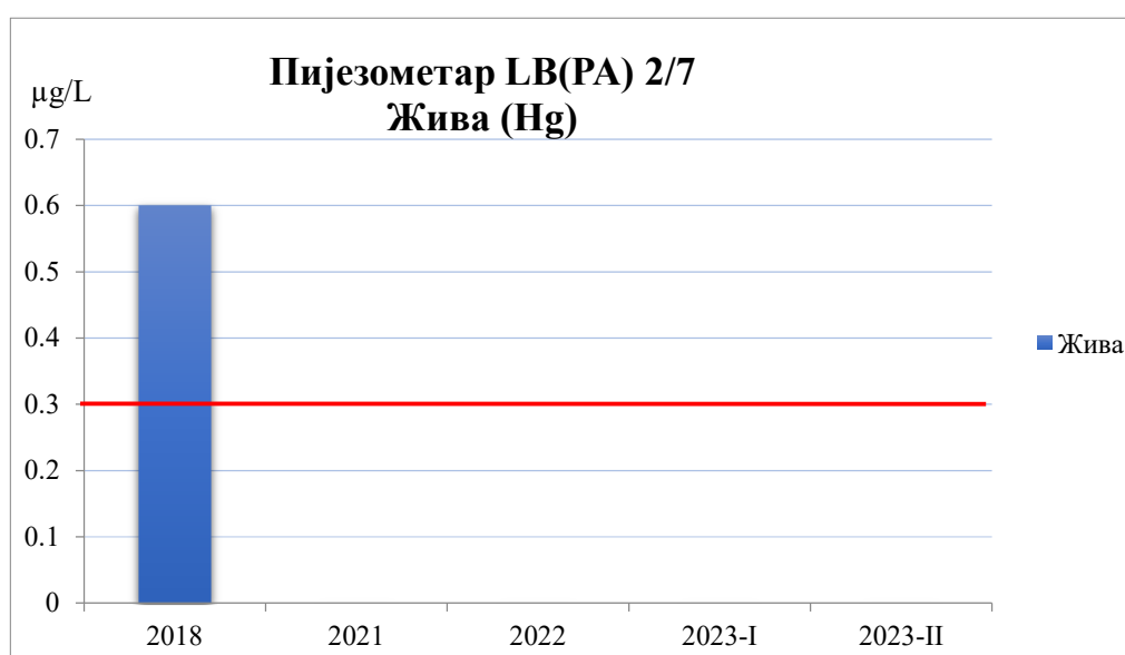
Слика 11. Концентрације живе у подземној води пијезометра LB(PA) 2/7
