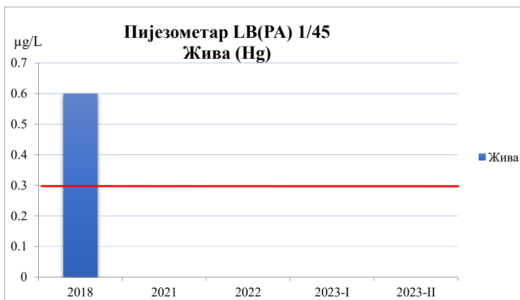
Слика 8. Концентрације живе у подземној води пијезометра LB(PA) 1/45
