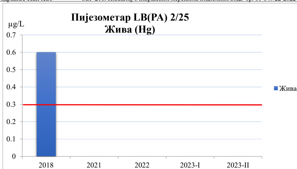
Слика 13. Концентрације живе у подземној води пијезометра LB(PA) 2/25
