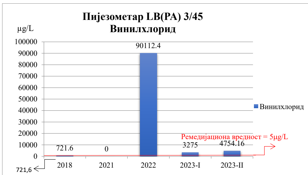
Слика 33. Концентрације винилхлорида у подземној води пијезометра LB(PA) 3/45
