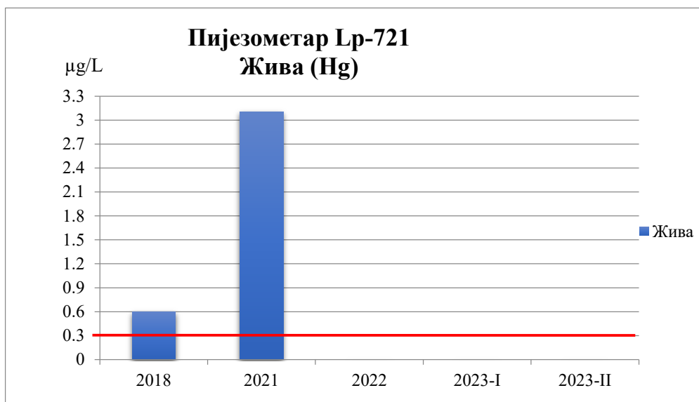
Слика 80. Концентрације живе у подземној води пијезометра Lp-721
