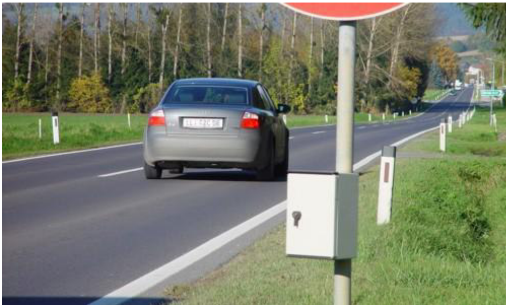
Slika PI.1 – Položaj uređaja Sierzega SR4 prilikom merenja
