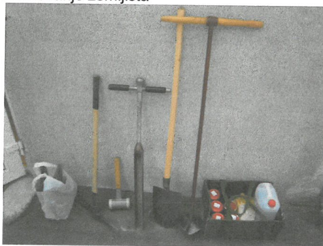
Slika 1. Oprema za uzorkovanje zemljišta
