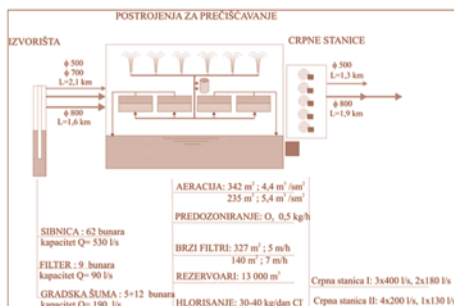
Слика 4.3 - Технолошка шема постројења за пречишћавање Панчевачког водовода
