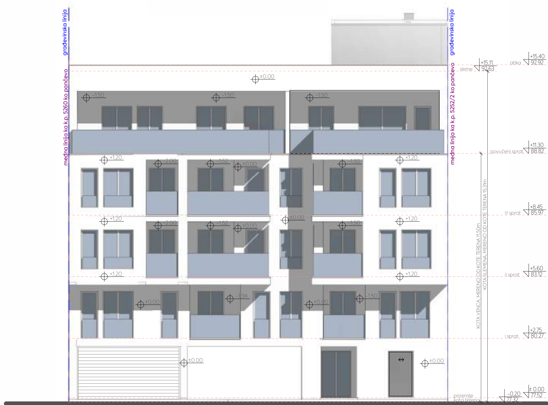
Fasada Lamele 1 orijentisana ka ulici Cara Dušana, maksimalni dozvoljeni procenat prepusta prema planu je 40%, ostvareni procenat prepusta je 20.39%, što je 55.07m 2 od ukupne površine fasade koja iznosi 270.04 2 .
