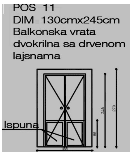
POS 11 Балконска врата у белој боји Šir.xVis. [cm]: 130 x 245 , доњи део је испуна висине 88 цм а у гоњем делу је термоизолоаоно стакло и лајсне око отвора и споља и унутра
