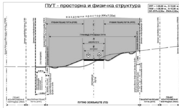
Слика 9: Просторна и физичка структура пута
